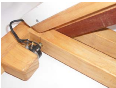
Figura 3. Potenciómetro para la medida del ángulo de elevación
