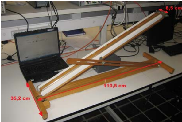
Figura 2. Aspecto y dimensiones del plano inclinado
